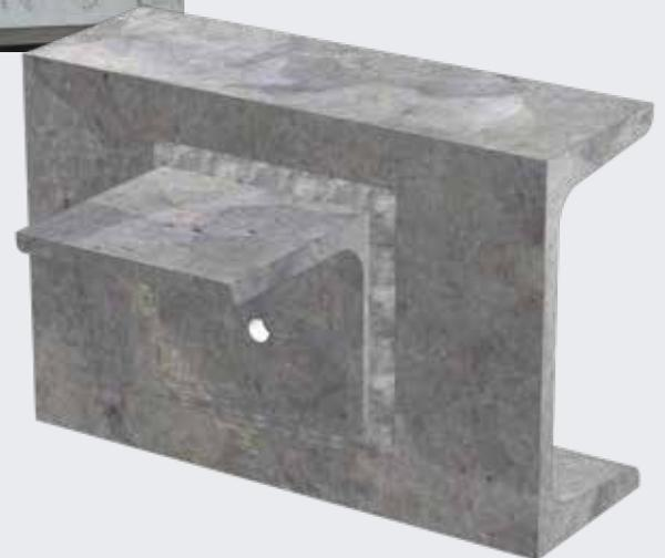
> Les pièces de renfort dans les profilés de types U, UPN, HEA... doivent permettre la libre circulation du zinc. Il est donc nécessaire de procéder à des grugeages ou à des perçages. Ces derniers doivent être au plus près des congés (coins) de la pièce.
