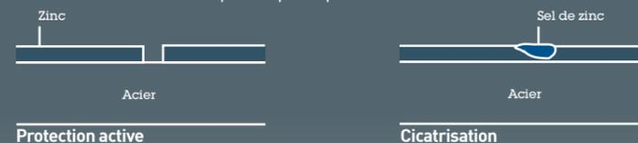
Les peintures n'offrent pas cette caractéristique, provoquant une oxydation qui va attaquer le support et passer sous le revêtement pour le décoller par l'intérieur : la rouille attaque !
