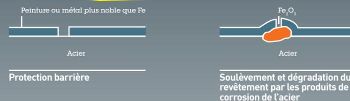
L'oxydoréduction est une réaction chimique au cours de laquelle se produit un échange d'électrons entre deux éléments. Celui qui capte les électrons est appelé oxydant (le fer dans le cas qui nous intéresse) ; celui qui les cède le réducteur (le zinc). Les caractéristiques électrochimiques naturelles du zinc, à l'image des piles de lampe de poche qui étaient au carbone zinc, sont utilisées pour encore plus de protection.
