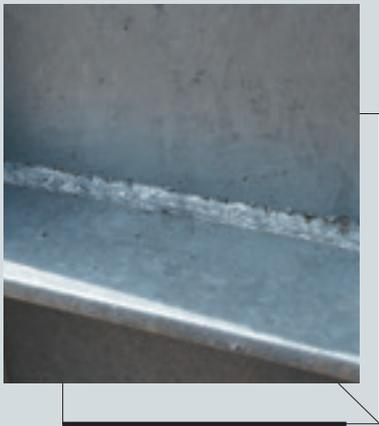
Le mode de fabrication de la pièce à galvaniser peut influencer la tenue ou agir négativement sur l'épaisseur de la couche de zinc. En effet, les procédés de découpe thermique laser, plasma, oxycoupage ou un usinage modifiant, comme la soudure, la composition et la structure de l'acier sur une zone résultant de la diffusion thermique.
