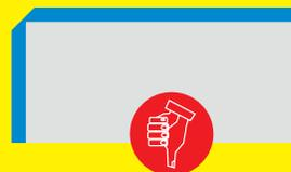
\_ Une arête saillante empêche une dépose conforme du revêtement, que ce soit pour la galvanisation à chaud ou pour la peinture.
