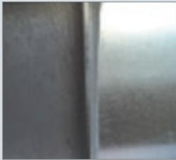
**Pour les aciers de catégorie A**, l'aspect sera brillant et lisse avec une épaisseur dans la moyenne des valeurs édictées par la norme NF EN ISO 1461, soit 35 à 70 µm. Cette épaisseur dépend de l'épaisseur de la pièce.
