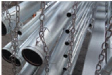
La solution passe par la pose de rondelles soudées sur le tube qui permettent la galvanisation de tubes complexes avec des coudes. Les rondelles sont ensuite meulées et une retouche de « riche en zinc » est effectuée à leur emplacement.
