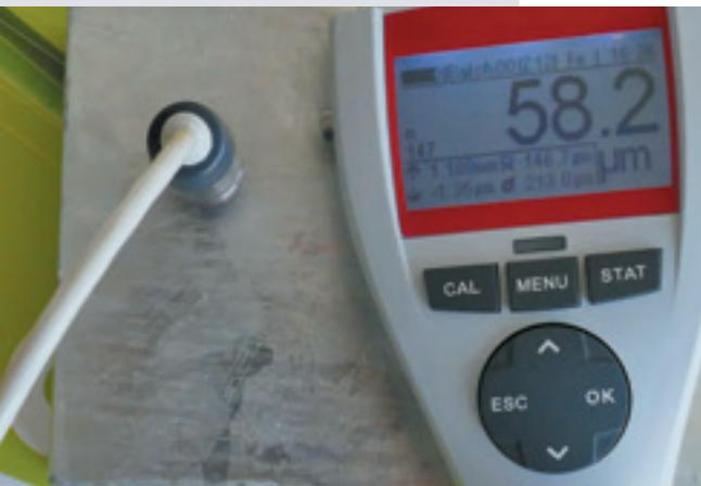
Ainsi, sur une plaque d'acier S240 - découpe laser de 20 mm, l'épaisseur de zinc obtenue est de 58,2 µm. La norme donne 70 µm de valeur minimale.
