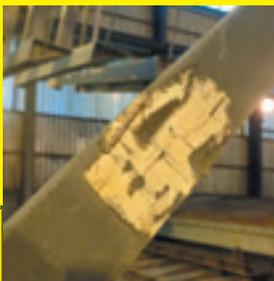
**Les traces de colle** dues aux étiquettes d'expédition ou de repérage **forment une barrière** empêchant la fusion fer/zinc dans la mesure où ces dernières résistent aux bains d'acide de décapage.
