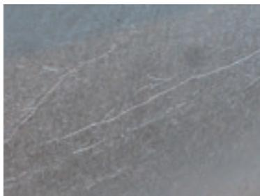
**Le galvaniseur ne peut pas anticiper ces défauts** : ils sont issus de l'acier de base et provoquent des défauts d'aspect visuels sans compromettre le critère anticorrosion.
