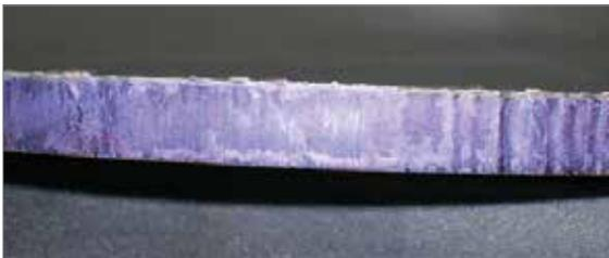
Les arêtes vives doivent être chanfreinées pour permettre la liaison fer/zinc de la galvanisation puis l'accroche de la peinture. Cette mesure est indiquée dans la norme ISO 12944-3 : préparation des pièces à la peinture.
