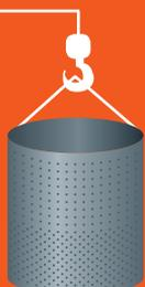
Le fond du panier s'ouvre et les pièces tombent dans un bac d'eau de refroidissement avant d'être pesées et mises en conteneurs.
