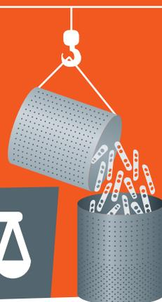
Les pièces sont déversées dans des paniers en acier, mis en rotation pour équilibrer leur répartition. Leur séchage se fait naturellement dans le panier. Le paramétrage de la ligne de galvanisation (cadence, temps...) est effectué.
