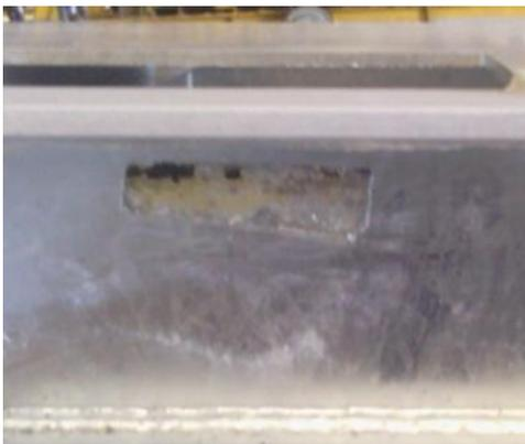
Les traces de colles dues aux étiquettes d'expéditions ou de repérages forment une barrière empêchant la fusion fer-zinc dans la mesure où ces dernières résistent aux bains d'acide de décapage.
