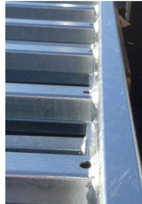
Il faut absolument supprimer les poches d'air qui en gonflant déformeraient de manière irréversible la pièce ou provoqueraient une explosion amplifiée si du liquide de décapage acide chlorhydrique venait à s'infiltrer dans le corps creux.
